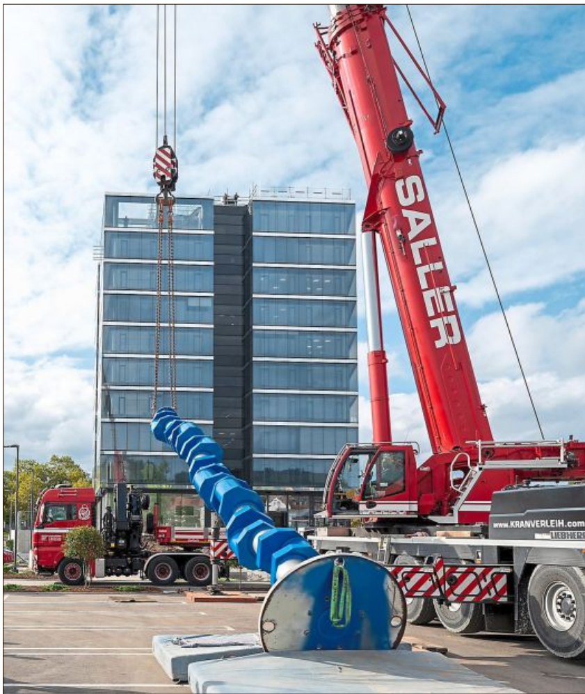
Ein wahres Schwergewicht: Diese Kurbelwelle, die zu den größten der Welt gehört, hat einmal circa 100000 PS bewegt.
