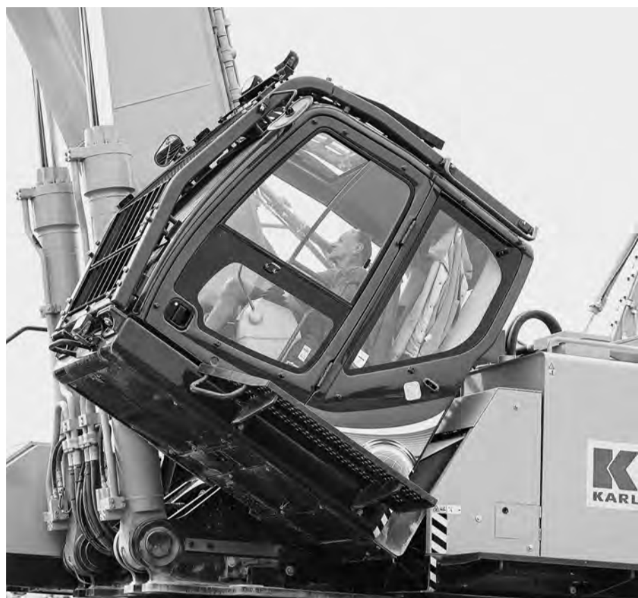
Eines der durch EMB Baumaschinen umgesetzten „Extras“ ist die Kippfunktion der Kobelco-Serienkabine, die den Baggerführer laut eigener Aussage selbst bei Arbeiten in geringen Höhen spürbar entlastet.
