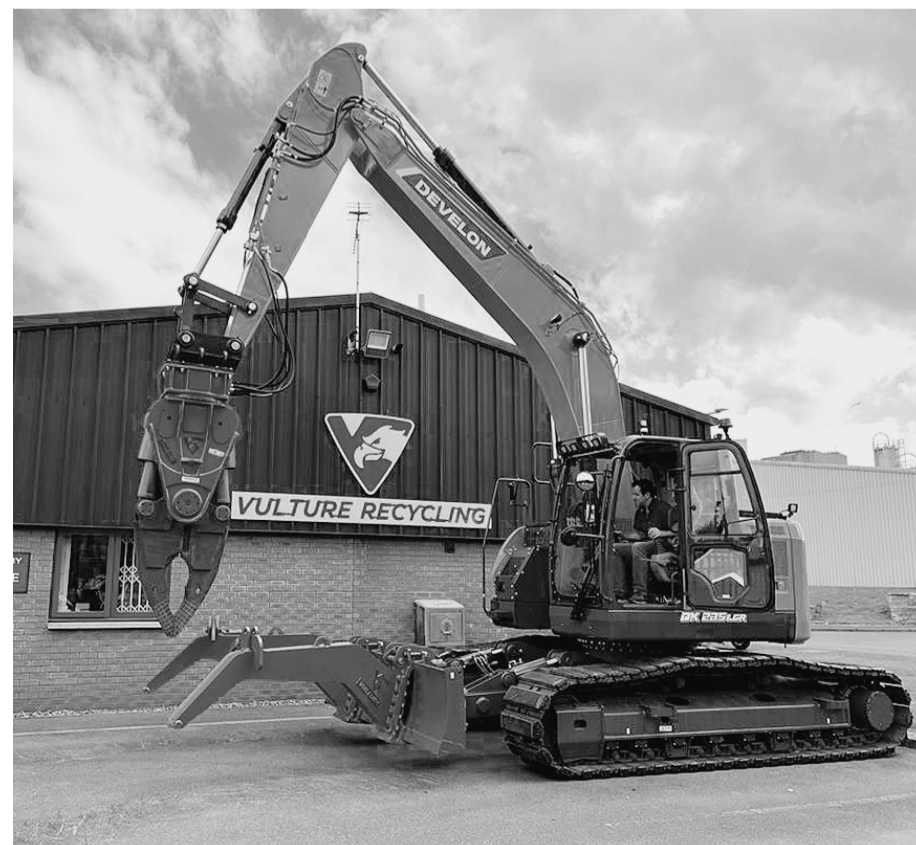
Das Multifunktionsgerät Indeco IMP 15 ist laut Hersteller jetzt noch effizienter und vielseitiger dank der neuen Greifer-Scheren-Konfiguration „Auto Dismantler“.
